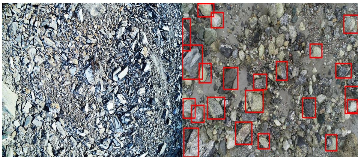
堰塞坝表层颗粒物质的智能检测
